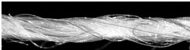
图1 T 36.9 tex(90/10)MVS纱纵向结构示例
